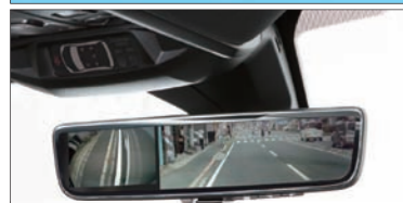
デッドアングル(左ドアミラー内蔵カメラ)映像表示
