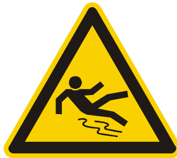
W028 Warnung vor Rutschgefahr
