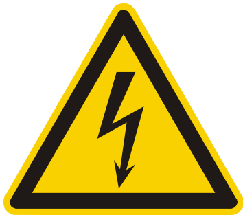
W008 Warnung vor gefährlicher elektrischer Spannung
