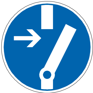
M014 Vor Arbeiten freischalten
