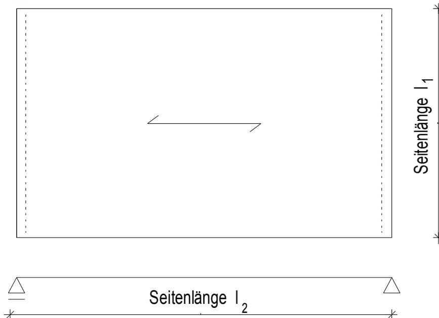
Das statische System ist eine Platte mit zweiseitig linienförmiger Lagerung. Annahme: Die Klemmhalterungen erfüllen die Anforderungen der möglichen Stoßbelastungen über den gesamten Nutzungszeitraum. Der Nachweis der konstruktiven Bedingungen nach TRAV, 6.3.2 ist durch ein allgemeines bauaufsichtliches Prüfzeugnis erbracht. Die konstruktive Bedingungen nach TRLV sind für den Nachweis einzuhalten.
