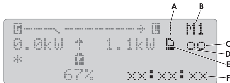
Abbildung 8: Status des Wechselrichters Sunny Island (Beispiel)
