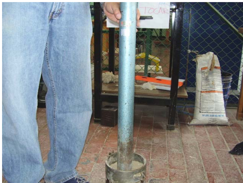
Figura 3.15. llenado y compactado del material en el molde.
