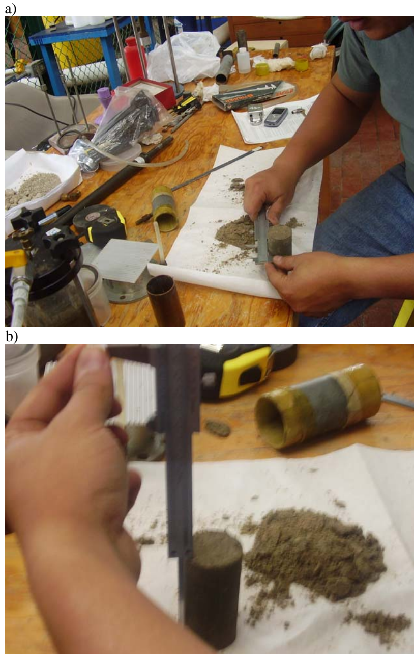
Figura 3.7. a) labrado de muestras; b) medición de muestras labradas.
