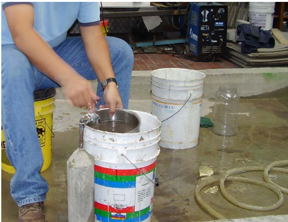
Figura 3.10. Lavado de muestras, a través de la malla #200.
