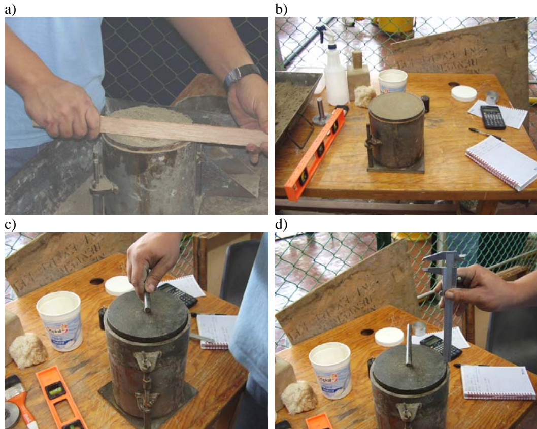
Figura 3.16. Enrase del material y medición inicial.
