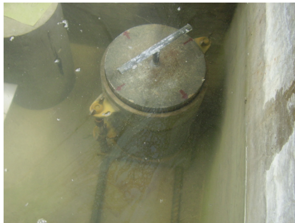
Figura 3.17. Proceso de saturación de la muestra, mediante inmersión en agua.
