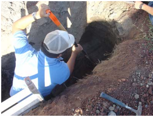
Figura 3.6. a) Obtención de muestras inalteradas. b) obtención de muestras alteradas. c) almacenamiento e identificación de muestras inalteradas.
