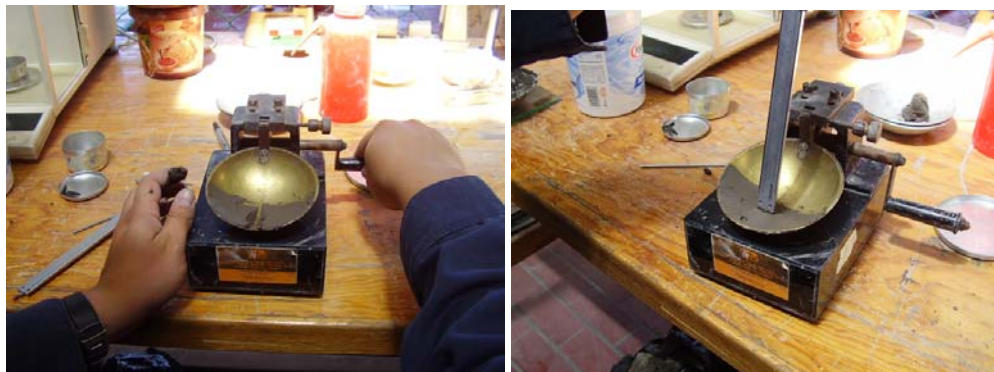
Figura 3.13. Determinación del límite líquido, mediante la copa de Casagrande.
