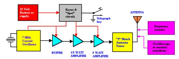
40 Meter 5 Watt QRP Transmitter Block Diagram
