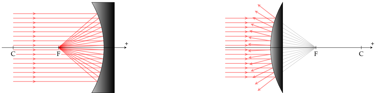
FIGURE 2.9 – Miroirs sphériques : miroir concave (à gauche) et miroir convexe (à droite).
