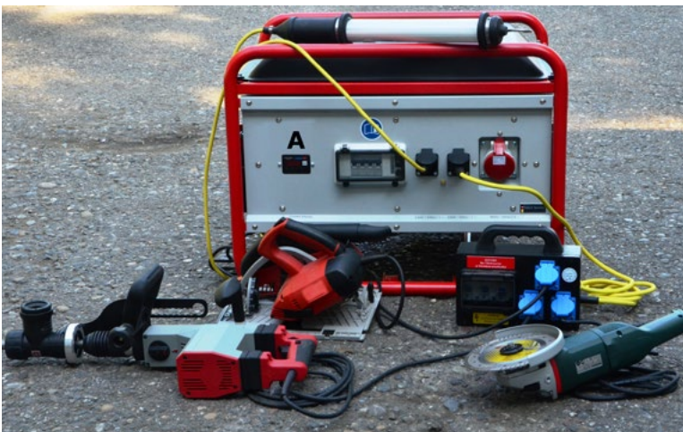
Abb. 25 Vier Betriebsmittel – Handleuchte direkt angeschlossen, drei weitere Betriebsmittel hinter einem Verteiler mit einer RCD für jede einzelne Steckdose
