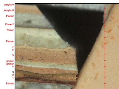
Stratigraphie / analyse des couches picturales réalisées au cours de la restauration des intérieurs de la Maison La Roche en 2009 - Salle à manger
