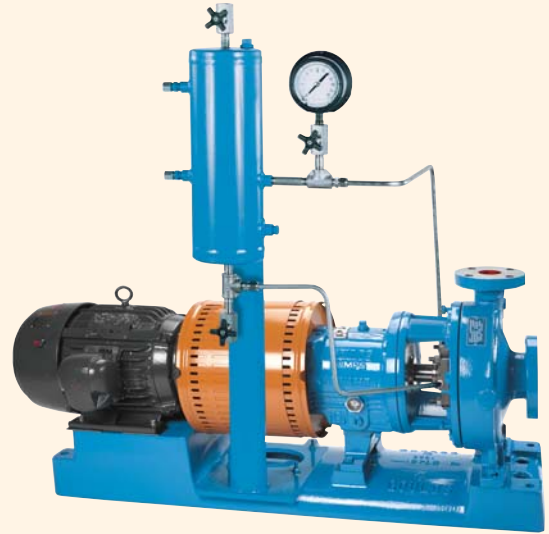
CPI PLAN 7353 La circulación presurizada lubrica caras dobles del sello.
