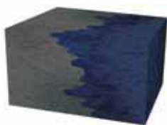
La coupe transversale du béton est exposée à l'eau.
