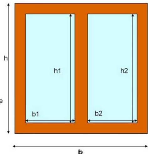
**Prospetto E.1: valori della trasmittanza termica lineare  $\Psi_g$  per i comuni tipi di distanziatori per vetro in alluminio e in acciaio; in caso di vetro singolo o pannello opaco con conducibilità termica inferiore a 0,5 W/(m.K) l'effetto distanziatore per vetro non c'è, pertanto come indicato al punto 5.1.1 - pag. 6 della norma, il valore  $\Psi_g$  è = 0.**
