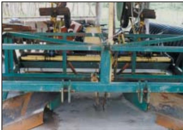
Foto 60 Máquina para hacer lomillos, colocar el plástico y la tubería de goteo.
