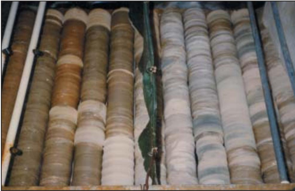
Foto 66 Parte interna de la cámara para el tratamiento químico (lado derecho) y para la aplicación de la cera (lado izquierdo).
