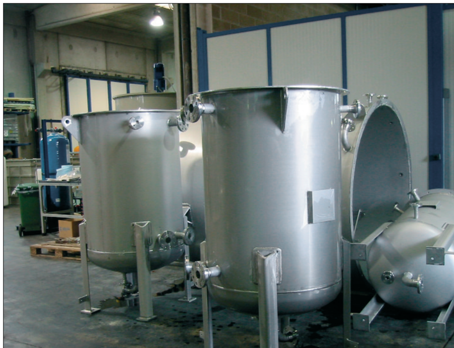
Fig. 6 Due manufatti prima e dopo l'operazione di decapaggio: sono chiaramente visibili i prodotti di ossidazione lungo i cordoni di saldatura. [per cortesia della società Delmet S.p.A., Gorgonzola (MI)]. Two products before and after the pickling operation: the oxidation products along the lines of welding are clearly visible. [source: company Delmet S.p.A., Gorgonzola (MI)].
