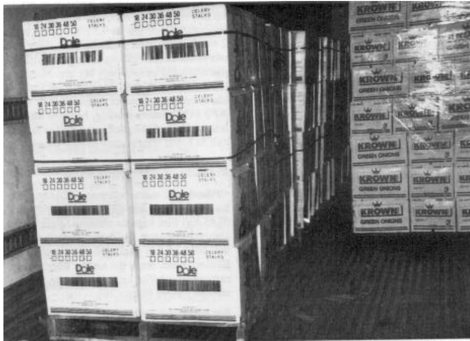
Figura 18. Una carga en paleta mixta de apio y cebollas verdes cargada unitariamente con flujo de aire
