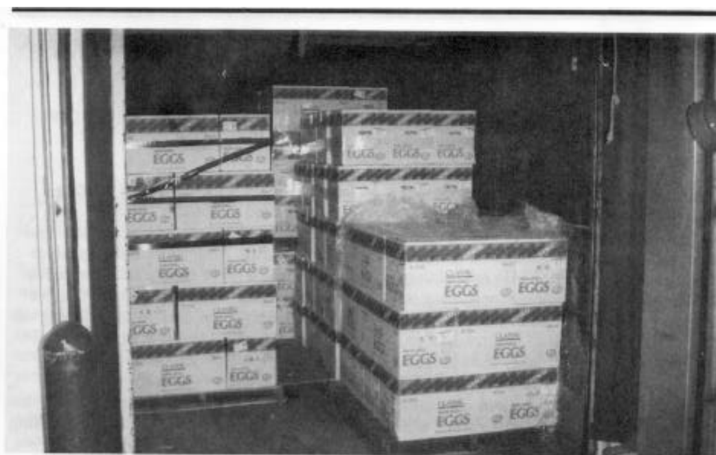
Figura 20. Carga de huevos en paletas, observese la película plástica alrededor de la cargas de la paleta en el área de la puerta trasera donde más se sienten los impactos del camino
