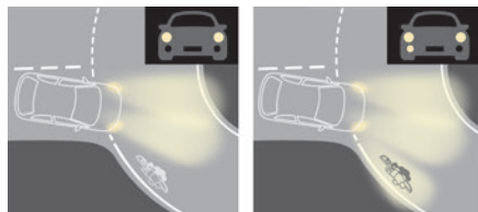
Sans / Avec éclairage statique d'intersection
