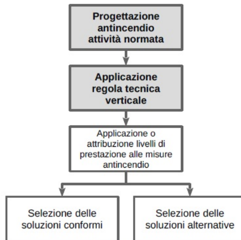
Illustrazione G.2-3: Progettazione antincendio delle attività normate
