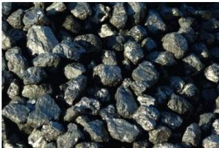
**El coque:** este combustible se adquiere a partir de la hulla destilada que se le agregan calcitas (minerales) para lograr una mejor combustión. Este proceso se realiza en hornos cerrados donde el combustible se somete a temperaturas sumamente elevadas.
