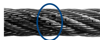
Fig. 43: Wire break nest
