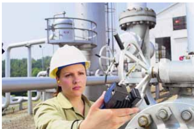
27 Misurazione della concentrazione dei vapori di solventi con fialetrici rivelatrici colorimetriche
