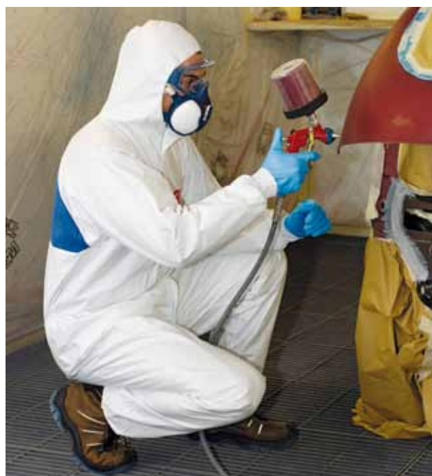
14 Spruzzatura di una pittura idrosolubile
