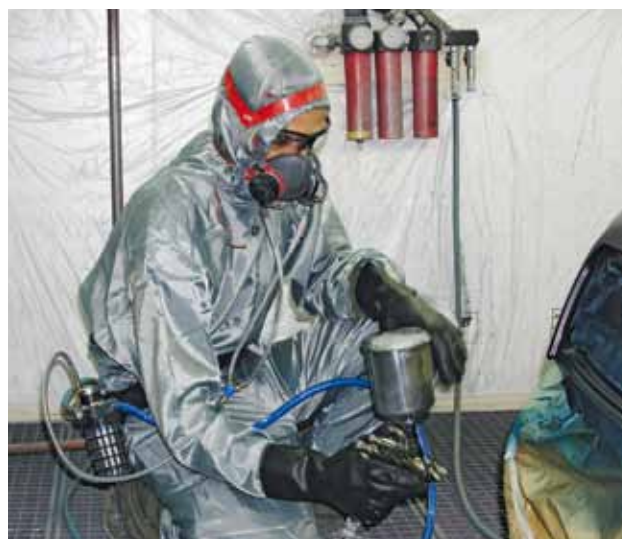
4 Spruzzatura di vernici a base di solventi con un respiratore isolante
