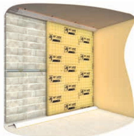
Embroschage de l'isolant GR32 et vue des bandes de membrane Vario® Xtra Band
