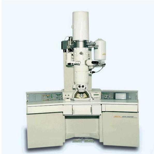
Figura 4: Fotografía de un microscopio electrónico de trasmisión.
