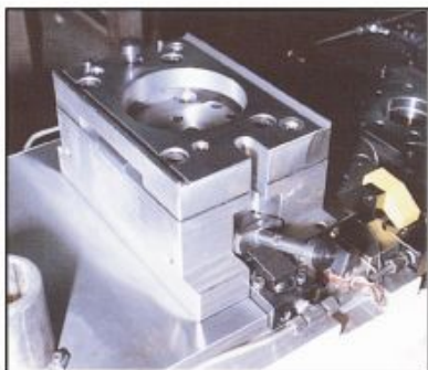
■ blank工程 : Blank station
